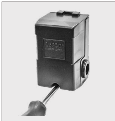
Figura 13 - Remoção do parafuso da tampa
